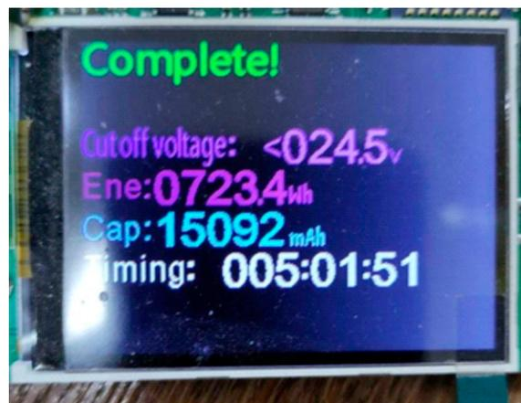
Фото 5. Состояние аккумулятора после теста
